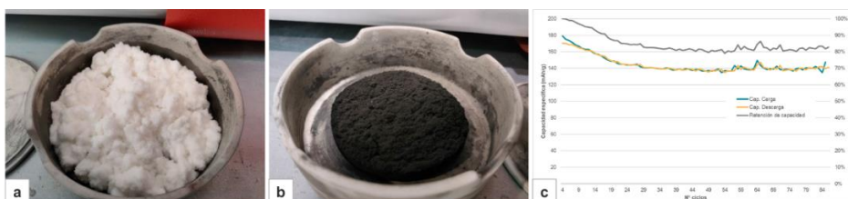
Fig.1. (a) Celulosa previa carbonización, (b) celulosa carbonizada y (c) resultados electroquímicos para semicelda ion litio, con ánodo con un 90% material carbonoso procedente de celulosa
